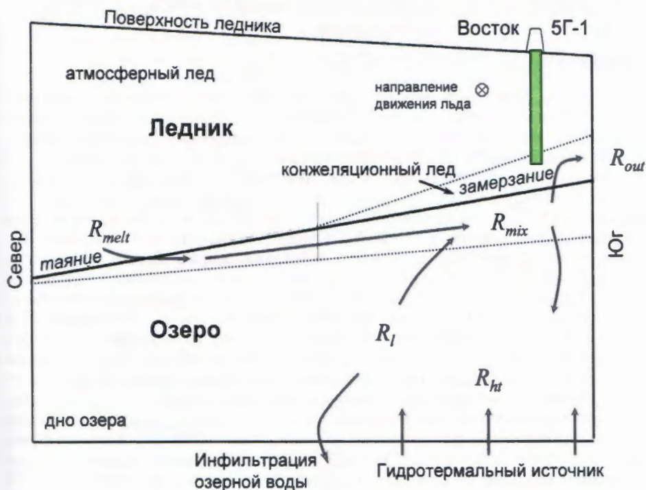
Рис. 13. Полутораслойная схема циркуляции воды и изотопного баланса озера Восток, предложенная в работе Ekaikin et al. (2010) (см. пояснения в тексте)
